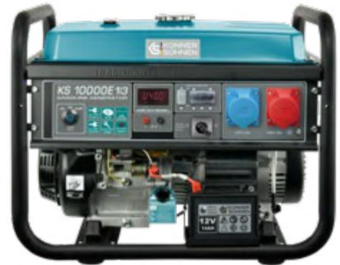
\*Les modèles de la série KS 10000E (monophasés) ont la possibilité de connexion de l'onduleur de soudage avec le courant max. à 200 A, à condition que l'onduleur de soudage ait le rendement de 85 % et la tension d'arc de 25 V.
