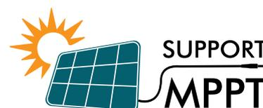
Le suivi du point de puissance maximale (MPPT) est une gestion intelligente qui suit et trouve constamment le point de puissance maximale dans votre système solaire. Cela signifie que même avec des changements de luminosité et de température, vous obtiendrez le maximum d'énergie de chaque cellule solaire.
