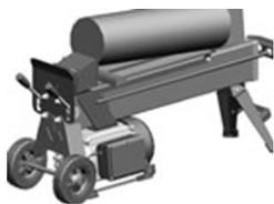
Lassen Sie beide Bedienelemente los, damit der Holzschieber zurückfahren kann. Legen Sie einen dreieckigen Holzkeil unter den Stamm, Holzschieber ausfahren damit dieser den Keil unter den festgeklemmten Stamm drückt. Löst sich der Stamm nicht, den Vorgang mit immer größeren Keilen wiederholen.
